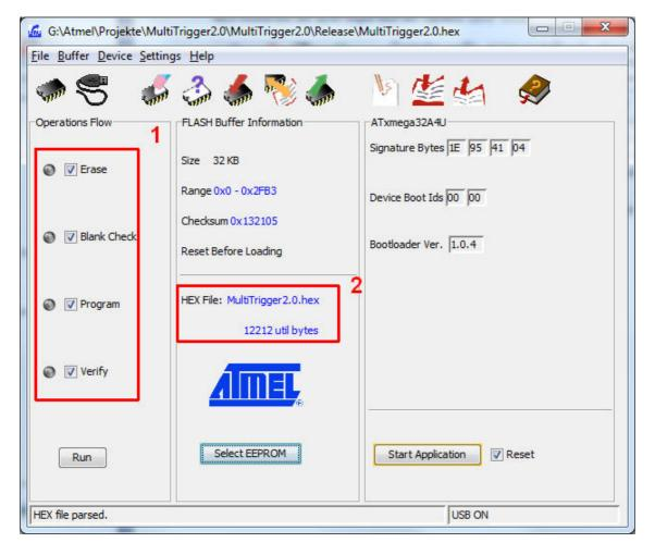
Nun klickt man auf "Run" und der Mikrocontroller des MultiTriggers wird zunächst gelöscht und dann programmiert.
