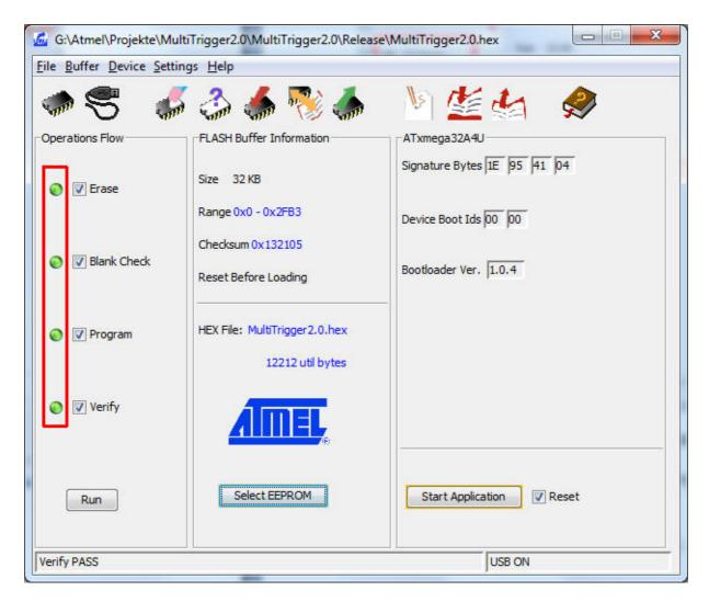
Nun kann über den Button "Start Application" der MultiTrigger neu gestartet werden. Oder man zieht einfach den USB-Stecker ab und schaltet den MultiTrigger wie gewohnt über den Power-Schalter ein. Der MultiTrigger wie gewohnt starten.
